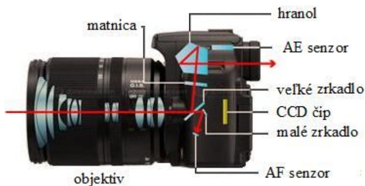
Obr. 3.5: Prierez digitálnym fotoaparátom [o6]
