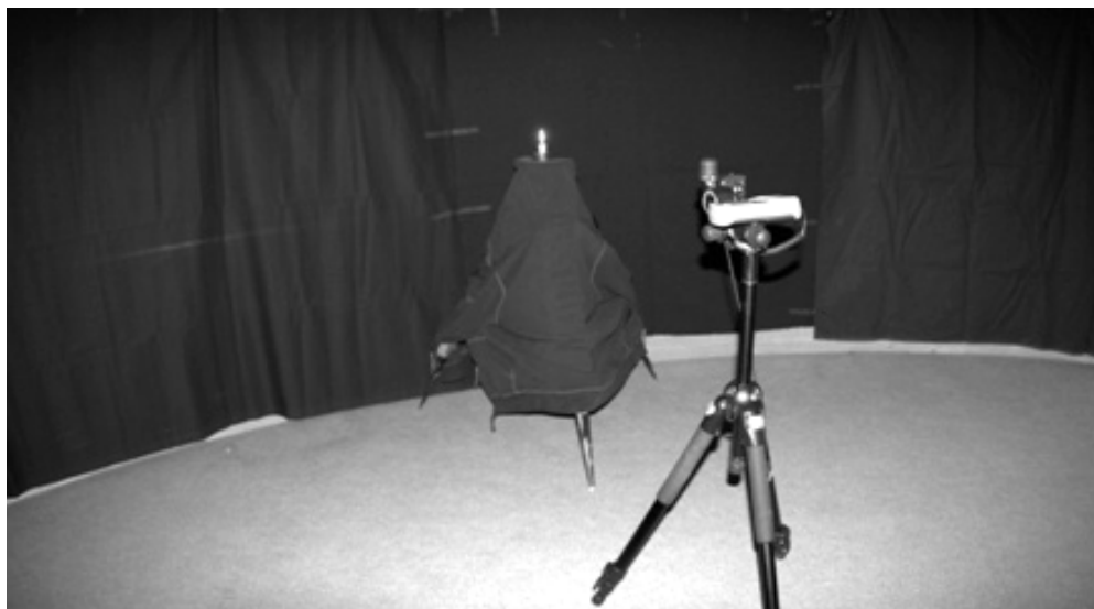
Obr. 4.1: Meranie smerovej charakteristiky luxmetra
