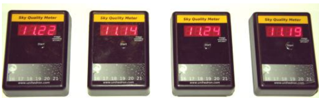
Obr. 3.14: Sky Quality Metre od firmy Unihedron
