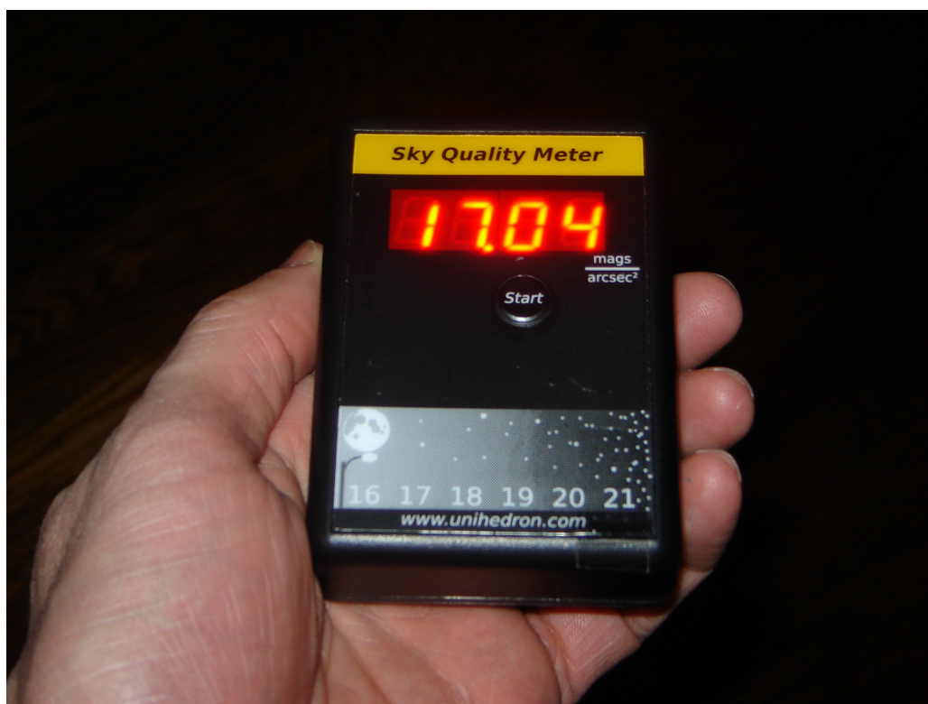
Obrázek 4.1: Jasoměr UNIHEDRON SQM-L v akci. Zdroj: Lettherebenight.com .
