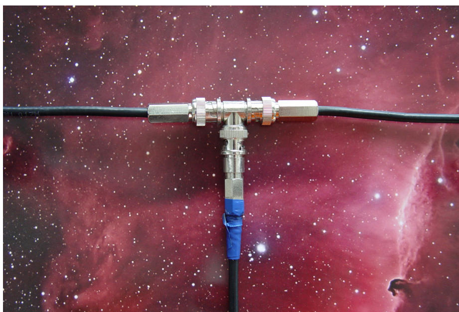
Obrázek 7.3 Vzájemné propojení koaxiálních kabelů. Z postranních vodičů přichází signál z jednotlivých dipólů antény, který je veden k přijímači už jediným koaxiálním kabelem.
