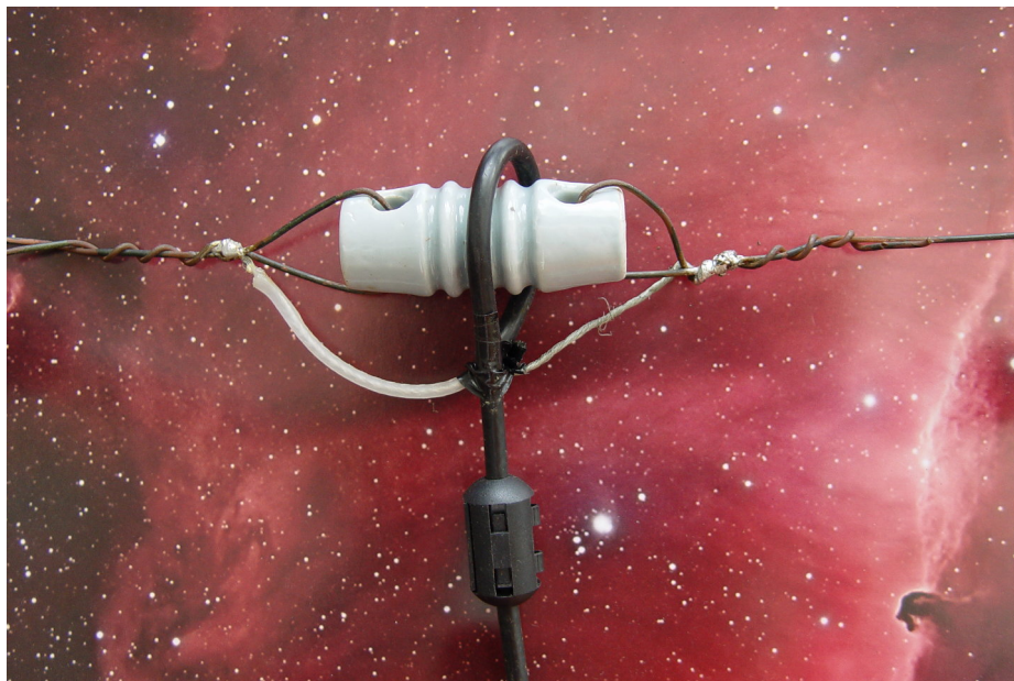
Obrázek 7.2 Připojení koaxiálního kabelu opatřeného feritovým prstencem k telegrafním drátům tvořícím jednotlivé ramena dipólu.
