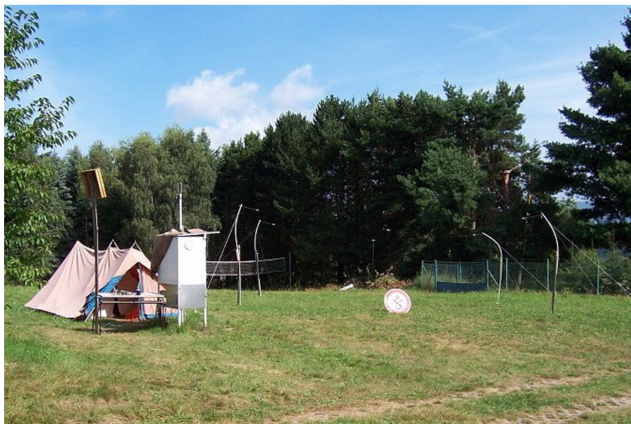
Obrázek 7.1 Anténní systém složený ze dvou spřažených dipólových antén pro příjem rádiových bouří ze Slunce a Jupiteru. Vlevo „radiostan“, který chránil cenné elektronické vybavení. Přítomná meteorologická budka posloužila jako zdroj elektrické energie. Foto: Marek Kolasa
