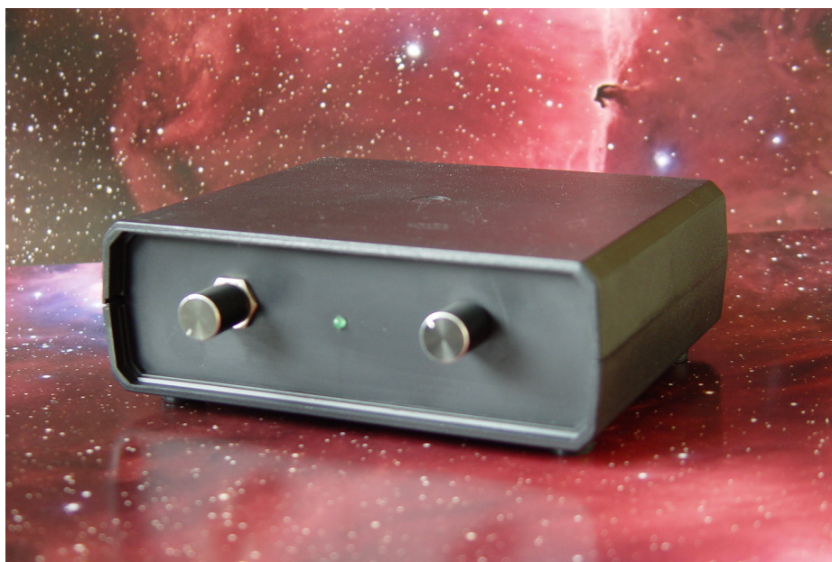
Obrázek 6.1 Pohled na rádiový přijímač JOVE z přední strany.
