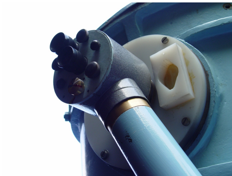
Obrázek 4.1. Optická hlava a fotonásobič v Newtonovom ohnisku
