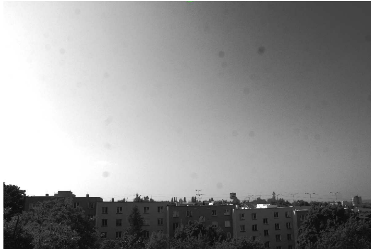
Obrázek 5.2: Toto je typická ukázka snímku, na kterém se projevují nečistoty usazené na snímači, případně na čočkách objektivu.
