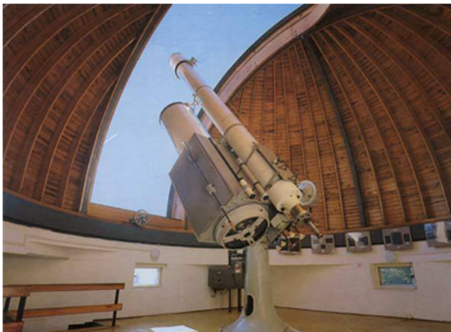
obr. 2 – 0.57-m f/5.2 zrcadlový dalekohled Observatoře Klet'
