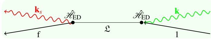
Obrázek 3.4: Rozptylový proces druhého řádu: nejprve je atom ve stavu |1\rangle , je excitován fotonem o vlnovém vektoru \mathbf{k} do mezistavu \mathcal{L} , v zápětí je vyzářen foton o vlnovém vektoru \mathbf{k}_s , a atom přejde do stavu |f\rangle .
