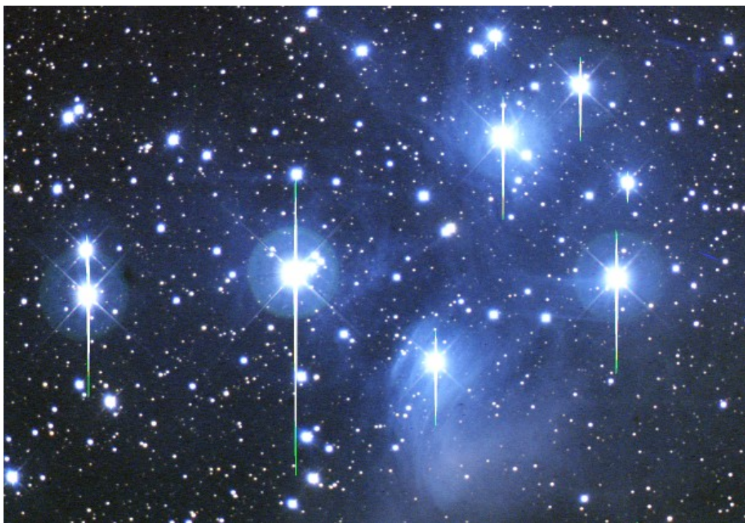
Obrázek 38: Blooming na CCD snímku otevřené hvězdokupy M42, který se projevuje jako svislé čáry od jasných hvězd, ve srovnání s difrakčními kříži vznikajícími na držáku sekundárního zrcadla [E23].
