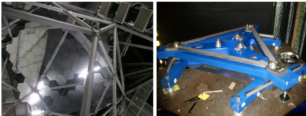
Obrázek 51: Segmentové zrcadlo dalekohledu SALT (South African Large Telescope, Sutherland - vlevo), na kterém je vidět různá kvalita odrazové plochy, vpravo je pak držák jednotlivého segmentu (foto autor).
