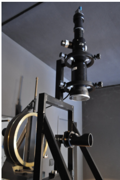
Obrázek 3.3: V levé části se nachází primární zrcadlo dalekohledu. Před ním se nachází zrcátko, jež odráží část světla do pointačního dalekohledu (horní část obrázku). Nahoře na pointačním dalekohledu je umístěna pointační kamera [15].
