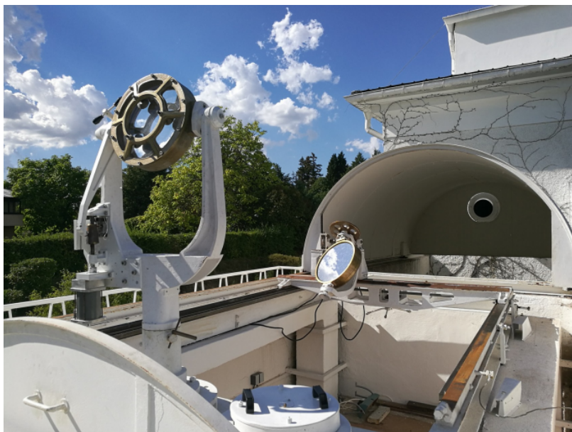
Obrázek 3.2: Coelostat: V levé části obrázku se nachází druhé zrcadlo, v pravé části od něj se nachází první zrcadlo. V pozadí se nachází posuvná střecha [15].
